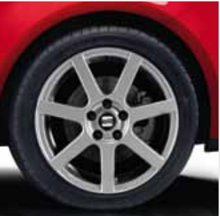
Llanta de aleación ligera de 7 radios en color plata metalizado mate, de 17". 7-spoke 17" light alloy rim in metallic matt silver. Jante de liga leve de 7 raios em cor prata metalizado mate, de 17". 5P0071490
