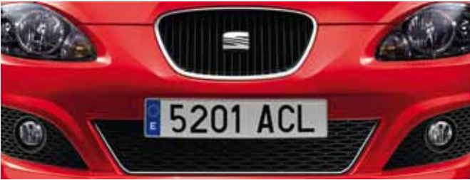
Moldura frontal cromada en la parte inferior del parachoques. Chrome front frame in the lower part of the fender. Moldura frontal cromada na parte inferior do pára-choques. 1P9052532
