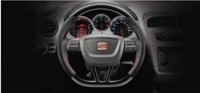
Volante deportivo negro. Volante original SEAT forrado con piel negra y pieza inferior en color negro piano. Black sports wheel. Original SEAT steering wheel with black leather and bottom in piano black. Volante desportivo preto. Volante original SEAT forrado com pele preta e peça inferior em cor preto piano. 1P9064241
