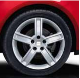
Llanta de aleación ligera de 5 radios en color plata, de 17". 5-spoke 17" light alloy rim in polished silver. Jante de liga leve de 5 raios em cor prata, de 17". 1P0071490
