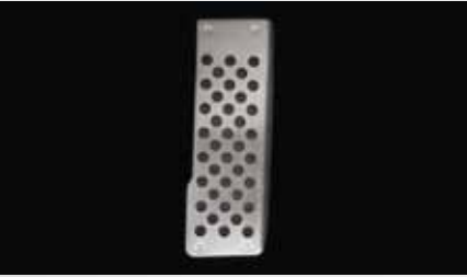
Reposapiés de aluminio de diseño deportivo con goma antideslizante. Aluminum footrests with a sports design and anti-slip rubber. Apoio de pés de alumínio de design desportivo com borracha antiderrapante. 1P9071750
