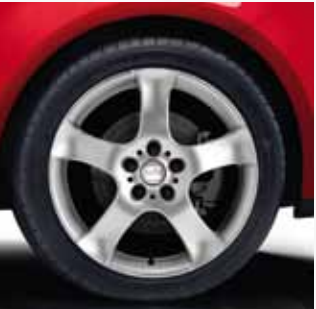
Llanta de aleación ligera de 5 radios en color plata, de 18". 5-spoke 18" light alloy rim in polished silver. Jante de liga leve de 5 raios em cor prata, de 18". 1P0071496
