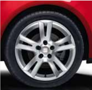
Llanta de aleación ligera de 5 radios en color plata, de 16". 5-spoke 16" light alloy rim in silver. Jante de liga leve de 5 raios em cor prata, de 16". 5P5071490
