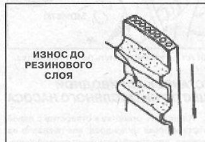
5. Сильный износ зубьев (конечная стадия). Износ корда на нагруженной стороне зубьев до обнаружения резинового слоя (уменьшение ширины зубьев)
