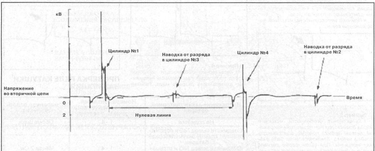
Рисунок 2.10 – Осциллограмма исправной системы зажигания (изменен масштаб изображения).
