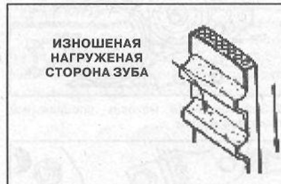
5. Сильный износ зубьев (конечная стадия). Износ корда на нагруженной стороне зубьев до обнаружения резинового слоя (уменьшение ширины зубьев)
