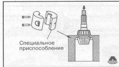
2. Установить уплотнитель. Используя специальное приспособление, установить большой подшипник ведущей шестерни редуктора.
